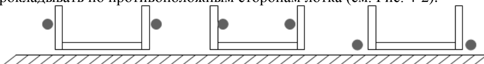
Рис. 4-2. Эскиз выполнения ШУП в лотках для цепей, идущих на ЗРУ 10 кВ и ЗРУ 6 кВ
